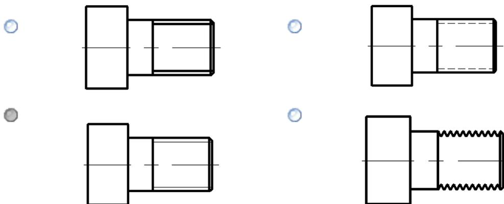
Правильное обозначение болта исполнения 2 с наружным диаметром резьбы 16 мм, мелким шагом 1,5 мм, длиной 50 мм по ГОСТ 7798-70...
